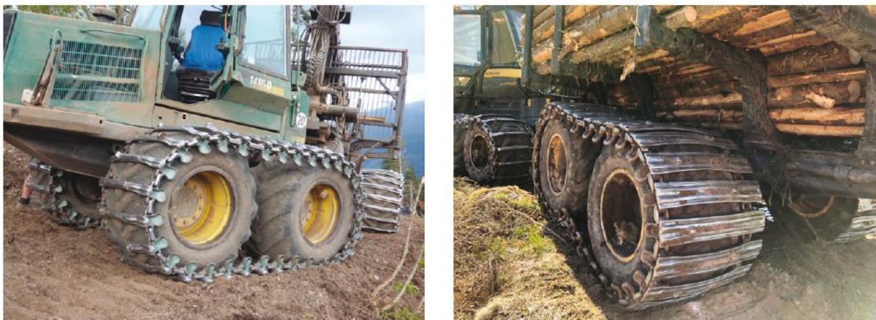
Figura 7-8 Particolari dei semi-cingoli forestali
