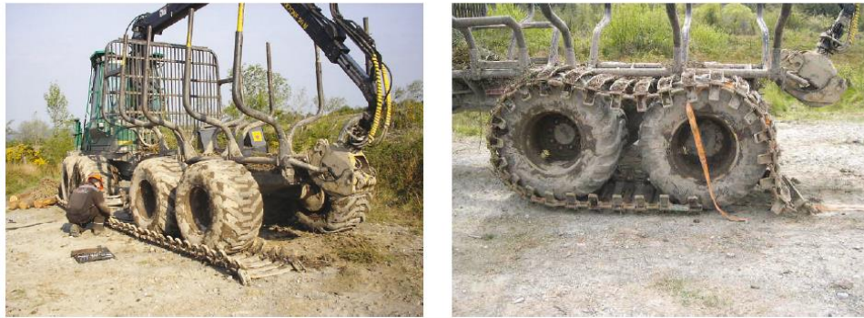
Figura 7-7 Fasi relative al montaggio dei semi-cingoli
